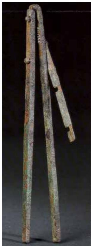
**Foto 3.** Livella romana (*libella*): a forma di A con traversa orizzontale graduata, che con il filo a piombo pendente da un punto, misurava il grado d'inclinazione di un piano.
