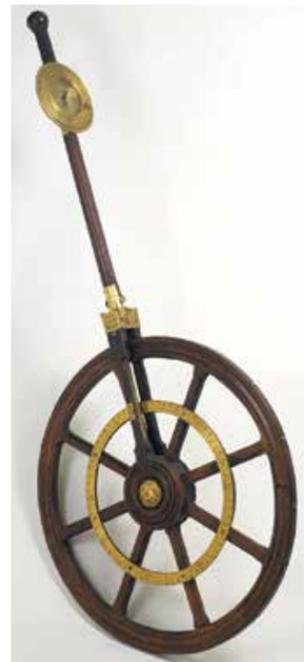
**Foto 9.** Il podometro serve a misurare le distanze percorse. È costituito da una ruota dal cui centro parte un manico, alla sommità del quale si trova un disco-registratore di ottone. Grazie ad un sistema d'ingranaggi, ogni giro della ruota (la cui circonferenza è nota) è registrato sul disco. Gli accademici del Cimento lo impiegavano per tentare di misurare l'arco di meridiano terrestre. Museo Galileo Firenze.
