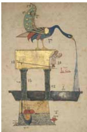
**Foto 3.** Illustrazione autografa della fontana del pavone di Al-Jazari. Azionando come leva la coda del pavone fuoriesce del becco l'acqua, e come la vasca sottostante si riempie un galleggiante aziona una fune, che fa apparire, da dietro una porta sotto il pavone, la figura di un servo, che offre il sapone. Quando si utilizza più acqua per risciacquarsi, un secondo galleggiante posto a un livello superiore provoca la comparsa di un secondo servo, questa volta con un asciugamano!
